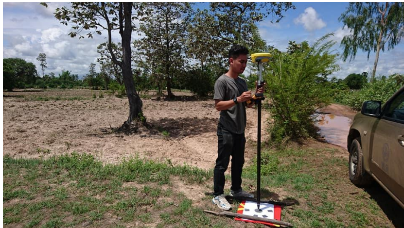
รูปที่ ๗ แสดง จุด GCP และการรังวัดตำแหน่ง
